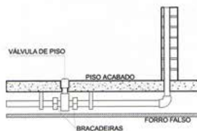
Instalação sob laje, com forro falso.
