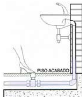
Instalação em rebaixo.
