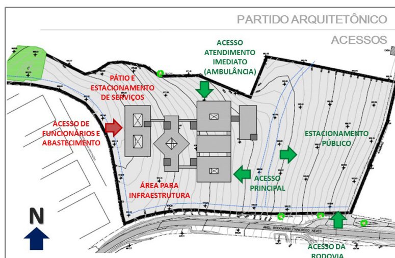
Figura 8 – Caso 3 - Plano Mestre Diretor Hospitalar para um novo hospital – Partido Arquitetônico e Acessos. Fonte: Badermann Arquitetos, 2016.
