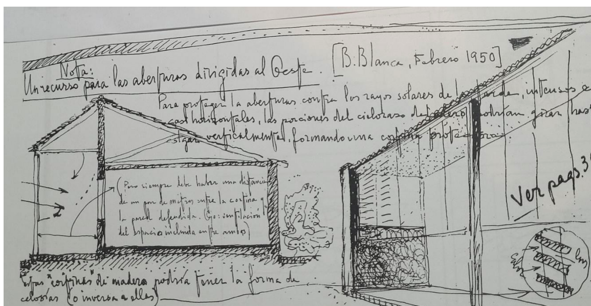
Figura 1. Estudo de aberturas em direção ao oeste, a partir da análise de beirais nessa orientação, chega-se à proposta de cortinas verticais protetoras. (ACOSTA, 2013).
